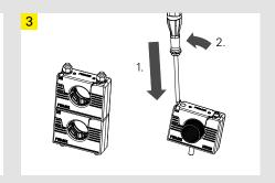
打开上盖,安装中间固定螺丝 (不包含在包装 里),安装波纹管。
