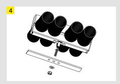
将不锈钢板穿进螺杆装入固定座上盖上。
