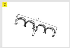
可选项: 使用一个六角螺母(螺母不包含在包装里)锁在螺杆上确保底座固定。
